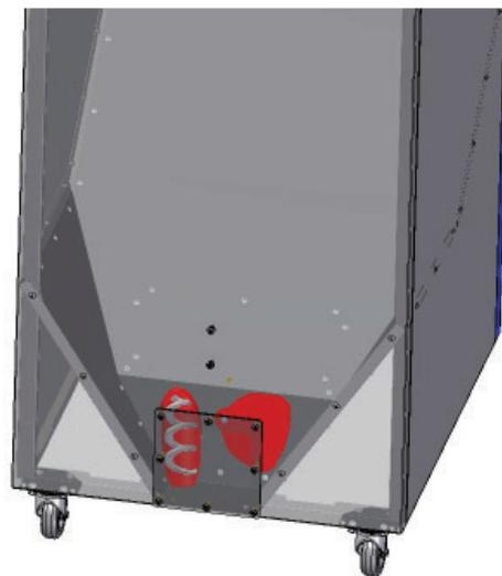
Étape 13 : Vérifier que la vis soit correctement positionnée et que le deuxième trou de passage de vis non utilisé (rouge) soit bien fermé
