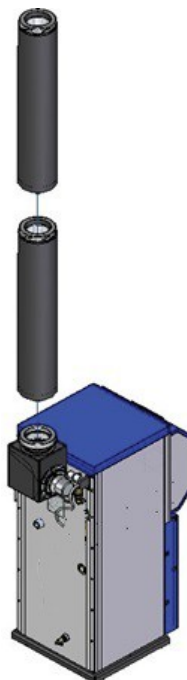
Étape 10 : Raccordement de la fumisterie en diamètre 125 mm. Veuillez vous assurer que la fumisterie soit conforme à une évacuation des fumées granulés
