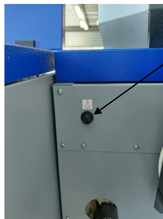
Accès au bouton de réarmement de la sécurité STB situé à l'arrière de la chaudière (dévissez le cache noir pour l'accès au bouton de réarmement)
